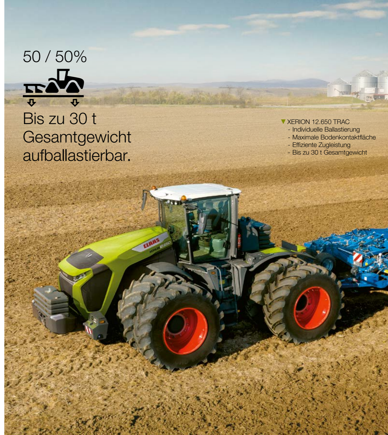
▲ Mit durchgehend 10 t Hubkraft am Heck ist der XERION für jede Herausforderung gerüstet.
