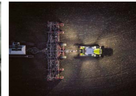
◀ Das High-End-Beleuchtungspaket mit bis zu 22 LED-Scheinwerfern leuchtet Ihr Umfeld im 360°-Radius mit 53.400 Lumen aus. Alle Scheinwerfer lassen sich passend zu Ihrer Arbeit einstellen.
