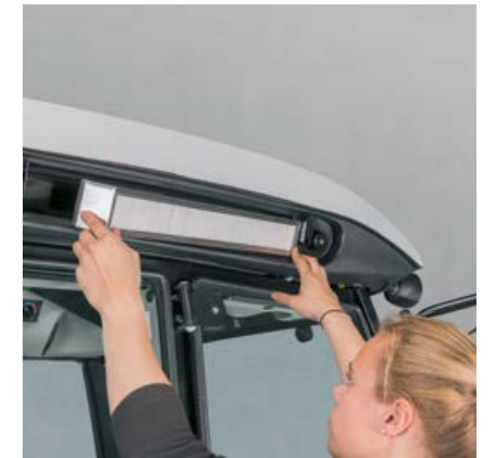
Der Kabinenluftfilter ist zum Reinigen von außen leicht erreichbar und sorgt jederzeit für frisches Klima in der Kabine.
