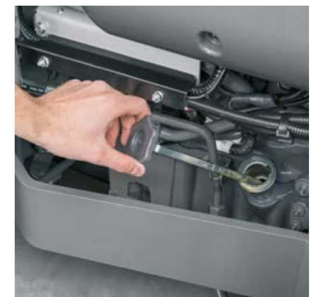
Ölstandskontrolle und Nachfüllen erfolgen bei geschlossener Haube an der rechten Seite des ELIOS 200.
