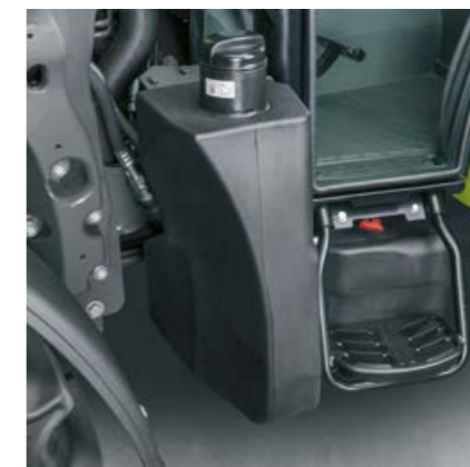
Der 95-l-Dieseltank und der 10-l-Harnstofftank bieten selbst an langen und intensiven Arbeitstagen ausreichend Reichweite.
