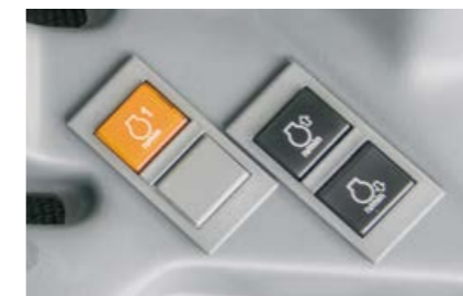
Zapfwellenarbeiten erledigen Sie mit dem ELIOS besonders einfach – dank des serienmäßigen Motordrehzahlsspeichers.
