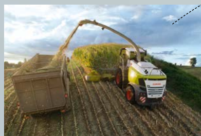
Stark kuptiertes Gelände findet man bei der Silomaisenernte in Neuseeland. Hier kommt bei den Kunden das JAGUAR Fahr-antriebskonzept sehr gut an: Differentialsperre, Allrad und die Reifendruckregelanlage geben dem JAGUAR optimale Traktion.
