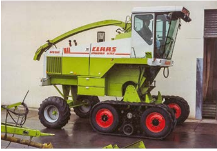
Die ersten Gehversuche des TERRA TRAC Laufwerkes auf dem JAGUAR wurden schon am JAGUAR 600 vorgenommen.
