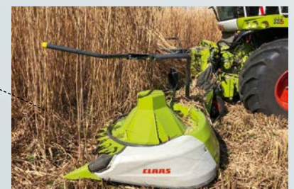
Als Brennstoff wird Miscanthus unter anderem in Österreich angebaut. Mit dem Maisgebiss lässt sich das Material problemlos ernten.
