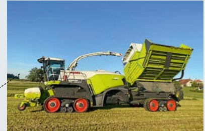
Eine Sonderlösung eines Schweizer Lohnunternehmer: Hier wird ein JAGUAR als Field Shuttle beispielsweise in der Grasernte in ebenen, aber auch stark hügeligen, kleinstrukturierten Flächen mit dem hangstabilen Raupenlaufwerk eingesetzt.
